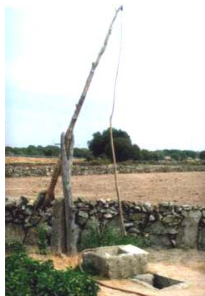
Figura 66. Cigüeño para sacar agua
